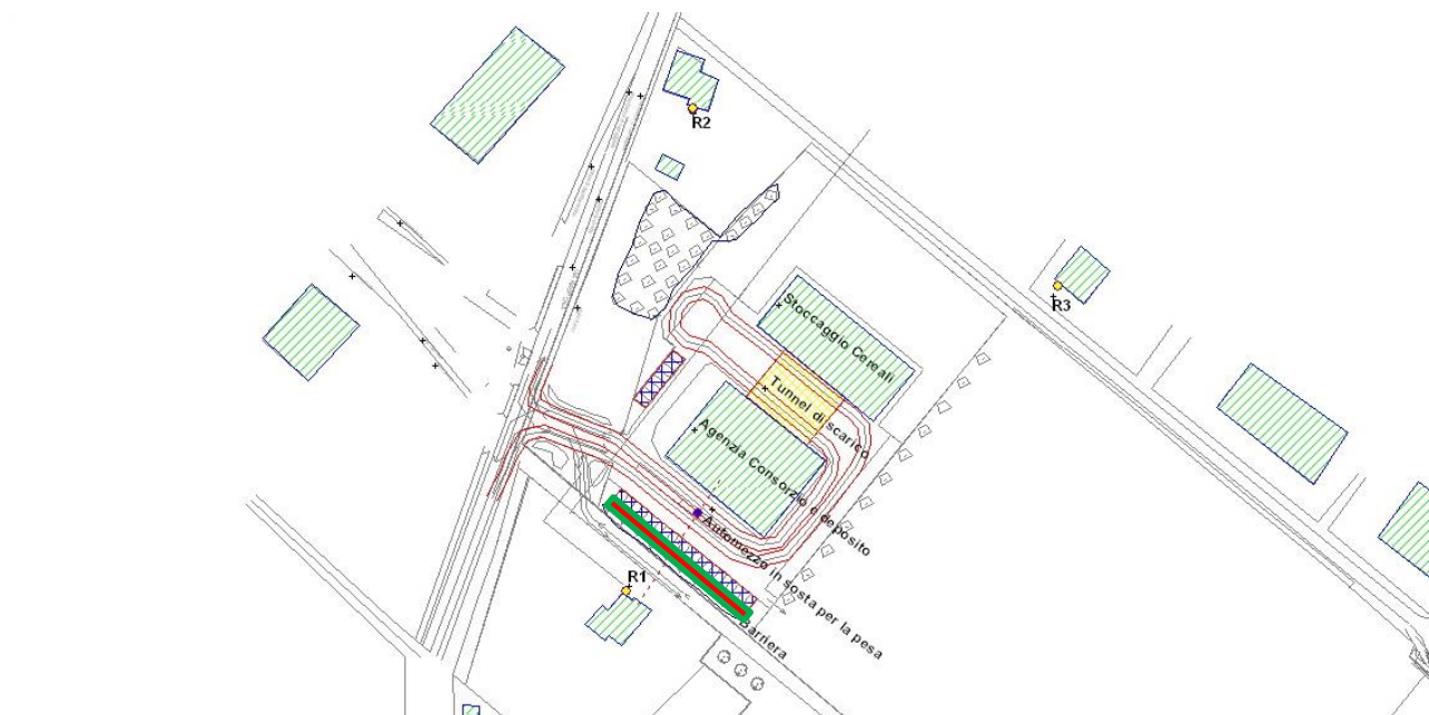
Fig. 15: Vista in pianta del modello in Sound Plan utilizzato per valutare l'effetto dell'inserimento di una barriera verde.
