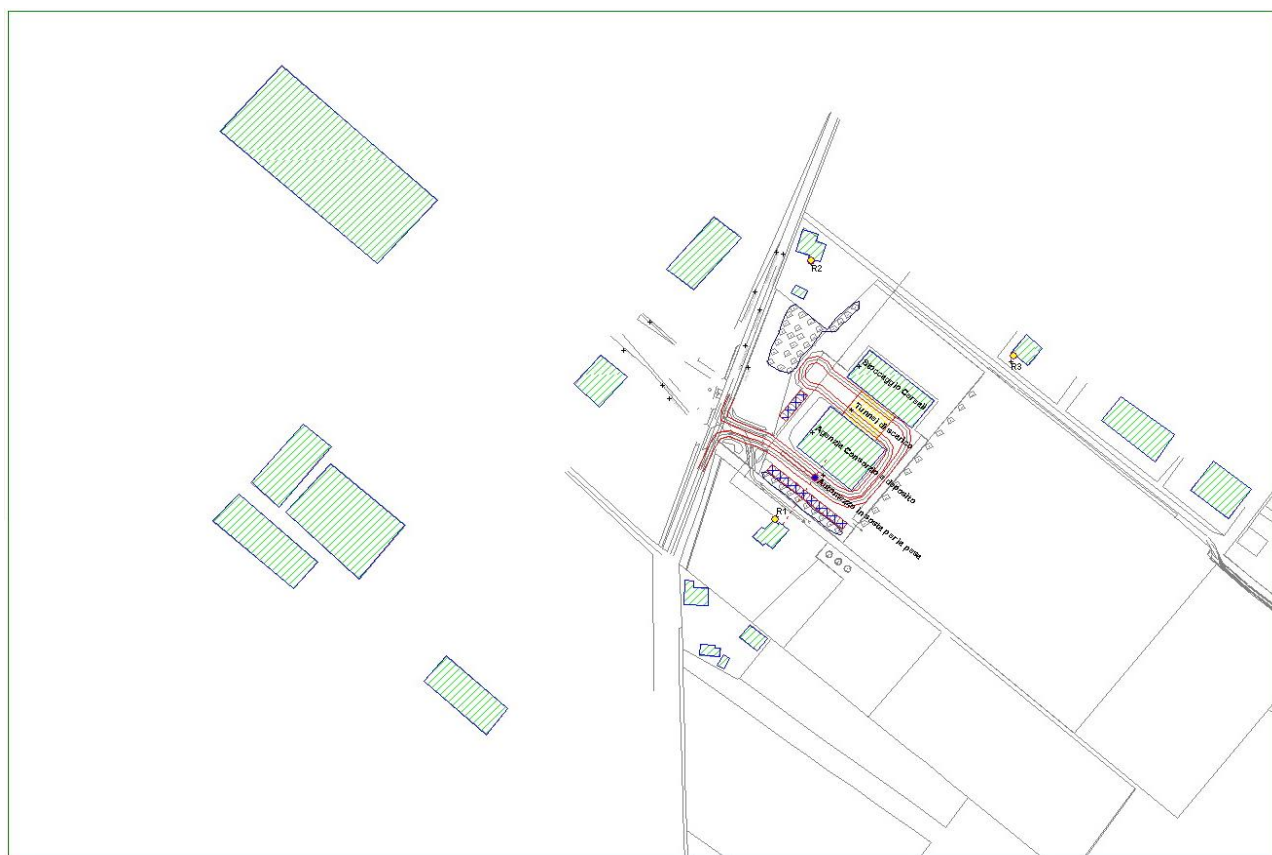
Fig. 13: Modello utilizzato per la simulazione, con indicazione delle sorgenti e dei ricettori disturbati.
